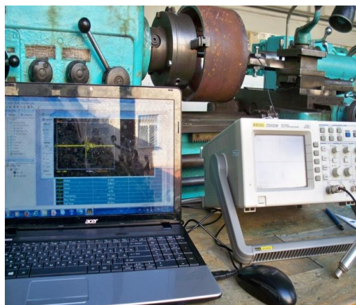
Рисунок 13 – Вид вимірювального комплексу для визначення власних частот
